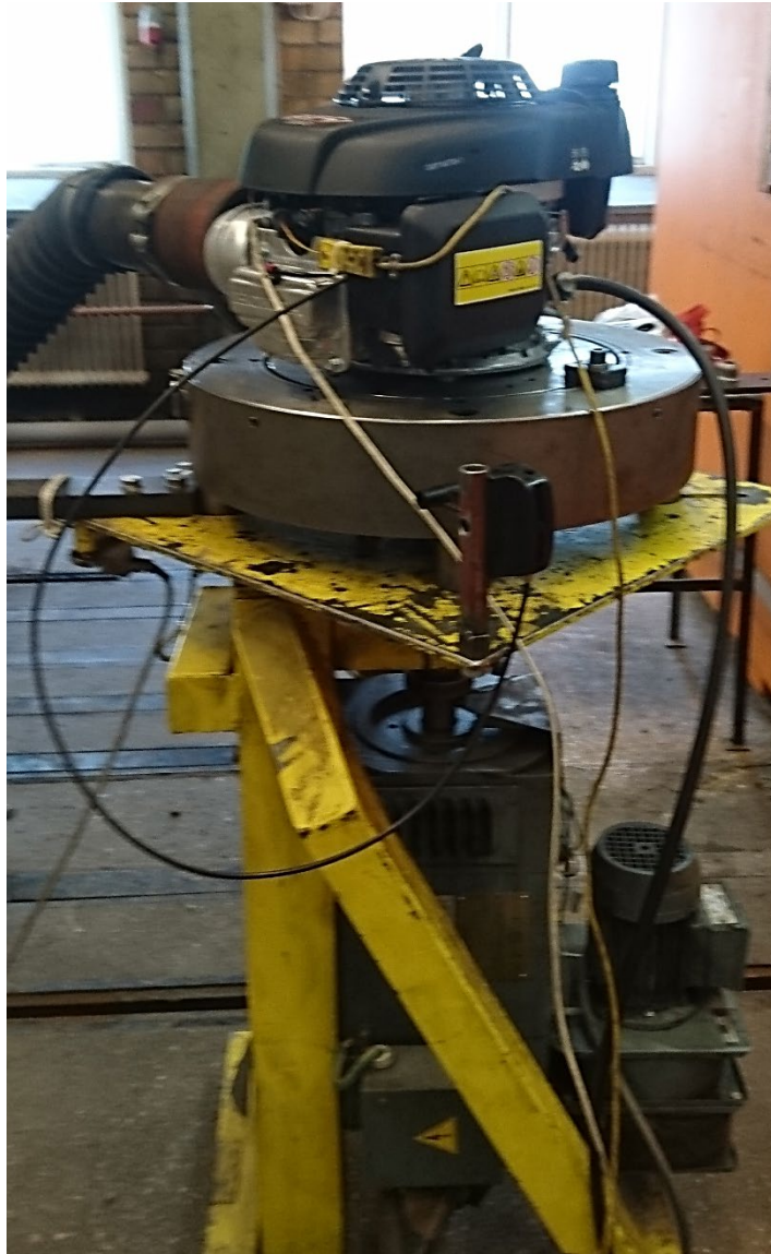
Bild 1. Motor kopplad mot likströmsbroms.
