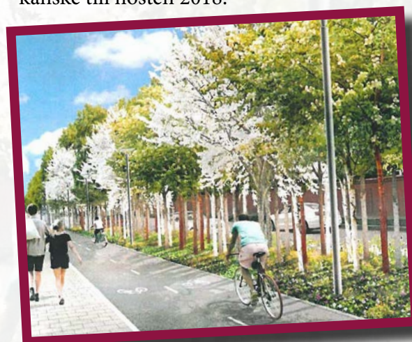
En trädallé planteras mellan körbana och cykelbana, för att få ett trevligare och tryggare stråk längs Bromstensvägen. Dessutom bidrar träden till omhändertagande av dagvatten. Trädslag som föreslagits är himalayabjörk, fågelbär, näverhägg och rönn.
