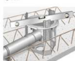
Fig. 3.8c. Golvbrunn ska vara minsta 100 mm i vägghöjd och i platt nivå med anslutningsrörskikt med en tolerans vägg på +2 mm mot från brunnen centrum till flänsens ytterkant.
